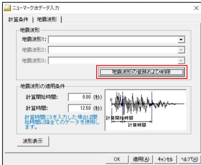
2. 「地震波形の登録および削除」をクリックします。
